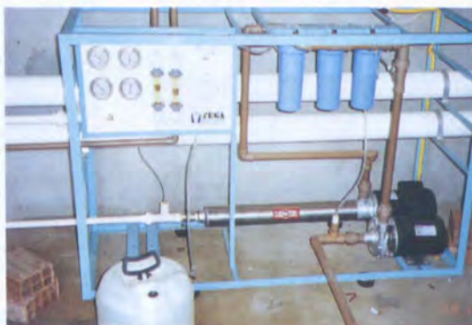
◆ Il dissalatore installato a Jacaré de Baixo (Paraíba, Brasile)
